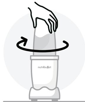
Переверните чашу и установите ее на основание с двигателем, слегка прижмите и поверните по часовой стрелке.
