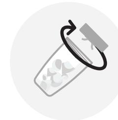
Установите нож со съемником на чашу и поверните его, герметично затянув.
