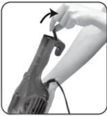
В месте для соединения корпуса пылесоса и удлинительной трубки расположен зажим, в закрытом виде он выполняет функцию заглушки. Откройте зажим для фиксации удлинительной трубки.
