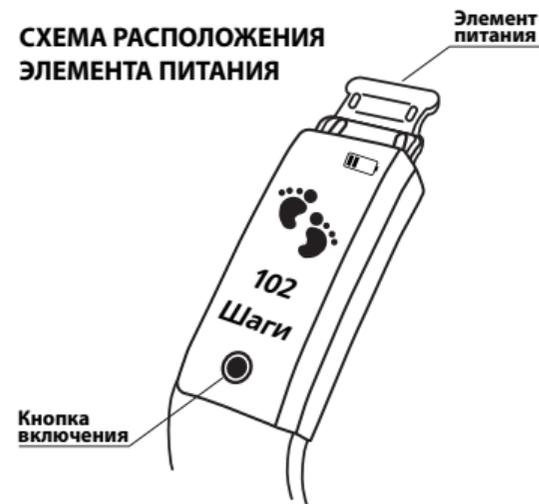
Элемент питания расположен на противоположной от кнопки включения стороне.
