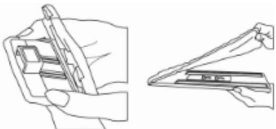
3. Вертикальный отжим с роликом и спойлером: установите рычаг регулятора отжима на необходимый уровень, сложите швабру и потяните вниз специальных механизм до конца насадки, затем поднимите его обратно вверх. Таким образом лишняя жидкость сольётся в ведро.
