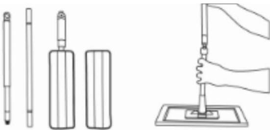
2. Прикрепите к платформе насадку: край насадки с карманами натяните на специальные пазы, которые находятся с двух сторон, затем равномерно приклейте на липучки.
