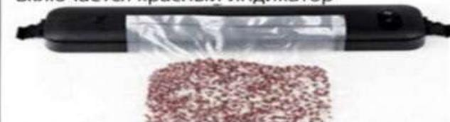
6. Нажмите на выпускной клапан, чтобы сбросить вакуумное давление. Когда снова загорится вакуумный индикатор, процесс упаковки завершен.
